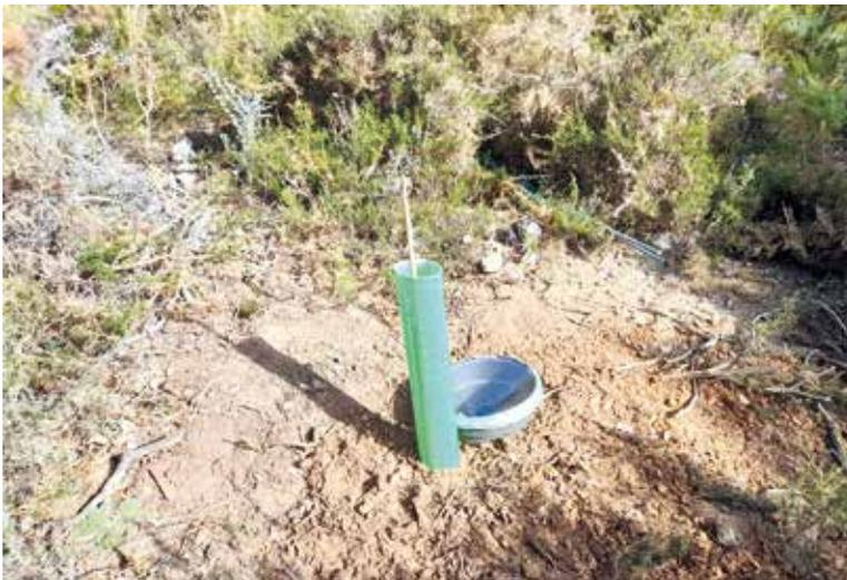
Arriba. Sistema de riego de repoblaciones forestales mediante destilación solar.
